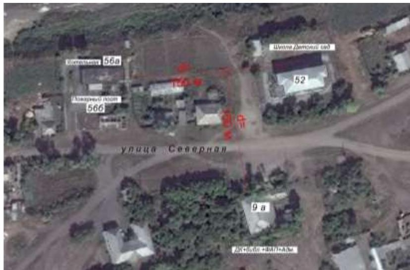
Рисунок 2.5 – Схемы тепловых сетей от котельной № 33 с. Большое Гусиное
