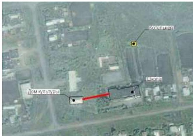
Рисунок 2.12 – Схемы тепловых сетей от котельной № 31 с. Новое Ильинское
