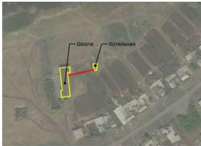
Рисунок 2.8 – Схемы тепловых сетей от котельной № 14 с. Новоберезово
