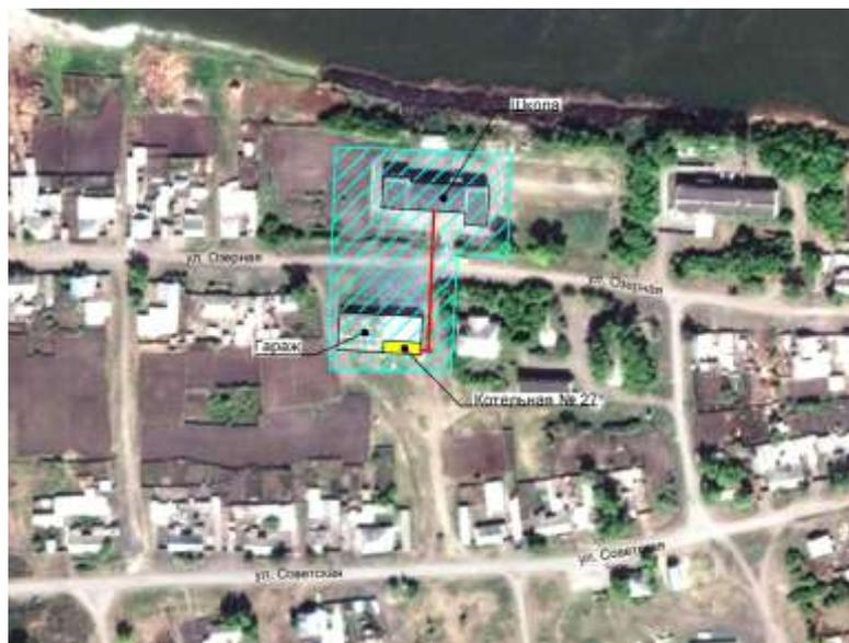
Рисунок 2.3 – Схемы тепловых сетей от котельной № 27 с. Стрельцы
