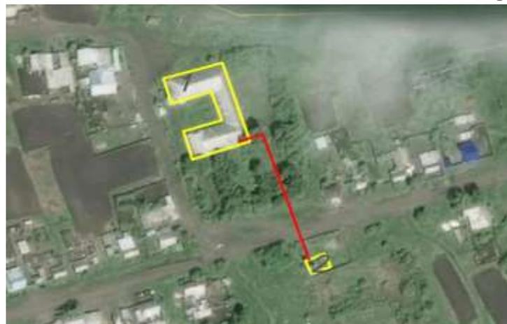
Рисунок 2.4 – Схемы тепловых сетей от котельной № 34 с. Большое Приютное (1 – школа, 2 – котельная)
