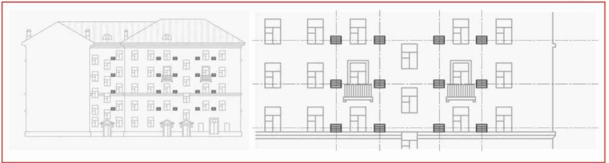
Пример правильного размещения кондиционеров на внутривором фасаде
